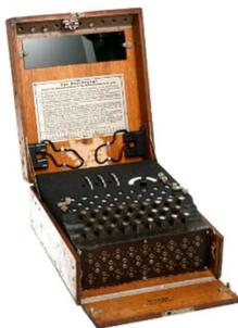
Die berühmteste Rotor-Maschine zur Verschlüsselung ist die ENIGMA, die vom deutschen Militär im zweiten Weltkrieg eingesetzt wurde. Das Wort »Enigma« kommt aus dem Griechischen und bedeutet »Rätsel«. Das Prinzip beruht auf einer drehbaren Scheibe, die jeden Buchstaben durch einen anderen ersetzt, dann gedreht wird und nun jeden Buchstaben durch einen anderen als zuvor ersetzt. Die Enigma hatte mehrere Scheiben. Sie wurde erst nach einigen Jahren durch intensive mathematische Forschung geknackt.
